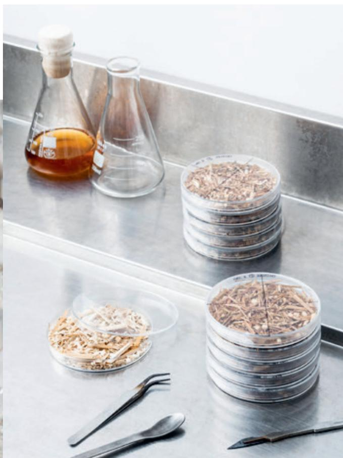
**Futtersuche** – auf welchem Nährboden das Myzel wächst, wirkt sich auf das Material aus, das entsteht. Unternehmen wie Mogu tüfteln im Labor am passenden Substrat.
