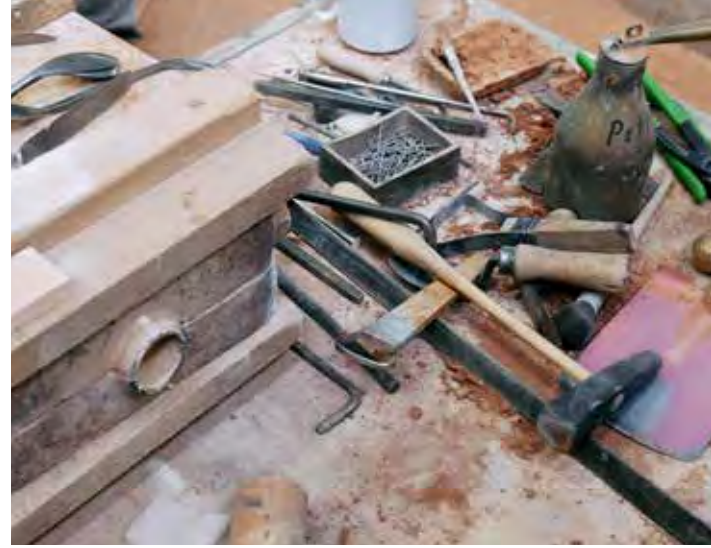
Aus Sand gebaut – Werkzeuge für das Sandformverfahren
