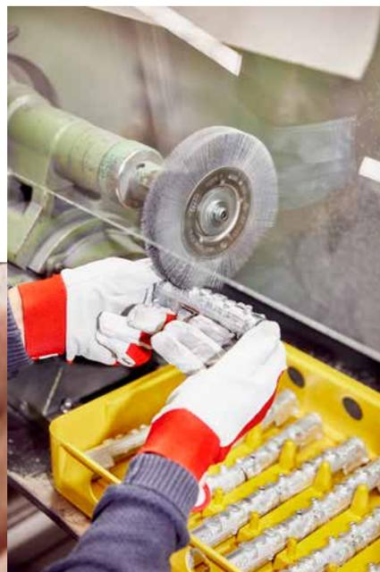
*Räder und Lokomotivkessel werden im Zinkdruckgussverfahren gefertigt. Nach dem Gießen werden die Rohlinge abgeschliffen und poliert. Selbst winzigste Schrauben stellt Märklin selbst her.*
